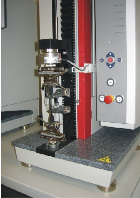
ISO 37'ye göre kauçuk çekme testi (ekstensometreli)
