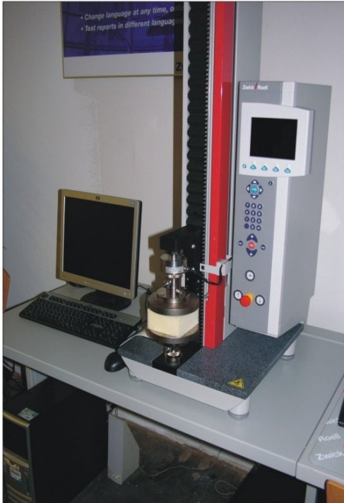
Sünger basma testi (compression set)
